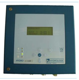
Nouveaux capteurs intelligents de mesure de hauteur d'eau, basse consommation, selon le principe du bulle à bulle, se déclinant en:
